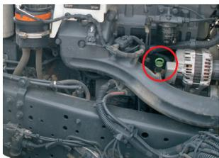
**Motoröl:** min. / max. bei abgestelltem Motor auf waagrecht rechte Fahrbahn!
