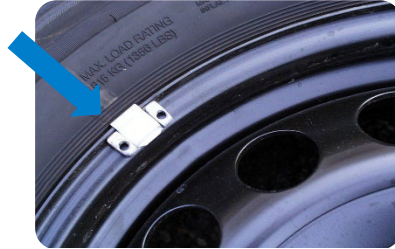
Wuchtgewicht Stahlfelge außen geklopft
