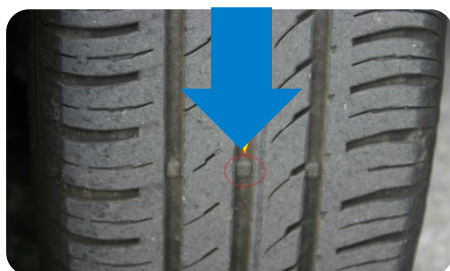
Kontrolle mit Indikator (oder Profiltiefenlehre)
