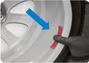
Wuchtgewicht Alufelge innen geklebt
