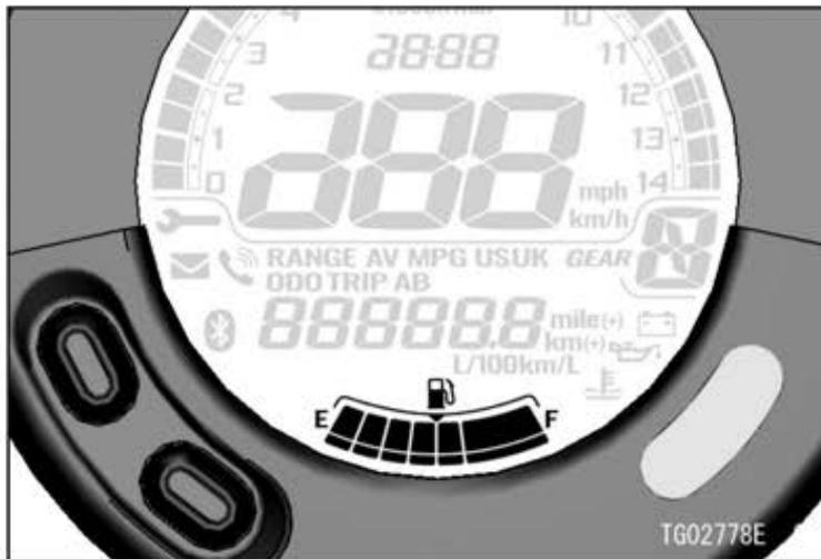
Der Kraftstoffstand im Kraftstofftank wird als Anzahl der angezeigten Segmente zwischen E (leer) und F (voll) angezeigt.
