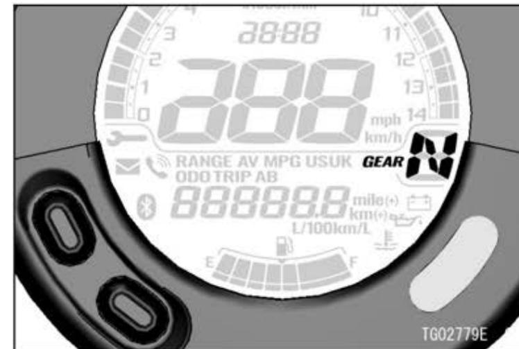
Die aktuelle Gangposition wird angezeigt. Wenn sich das Getriebe in Leerlaufstellung befindet, wird "N" angezeigt.
