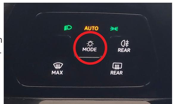
**Tagfahrlicht** (leuchtet nur vorne, hinten leuchtet nichts): Durch einmaliges Drücken der Mode Taste leuchtet das Abblendlicht.
