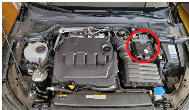
**Batteriebefestigung:** Kontrolle der Befestigung durch Bewegen der Batterie.
