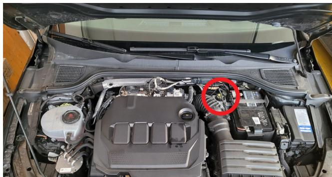
**Beurteilen des Bremsflüssigkeitsstandes:** Am Vorratsbehälter gibt es eine „MIN“- und eine „MAX“-Markierung. Die Bremsflüssigkeit muss dazwischen stehen. Sollwert über der Mitte des Behälters.
