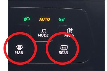
**Heckscheibenheizung einschalten:** Die Taste befindet sich am Armaturenbrett auf der „Licht Bedieninsel“ gleich rechts neben dem Taster der Windschutzscheibenheizung.
